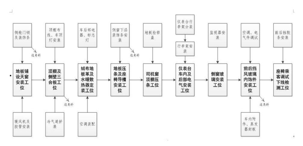
图 3.4.1 总装工艺流程图
