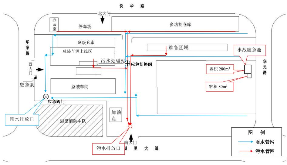
图 10.5.1 厂区雨、污水管网分布图
